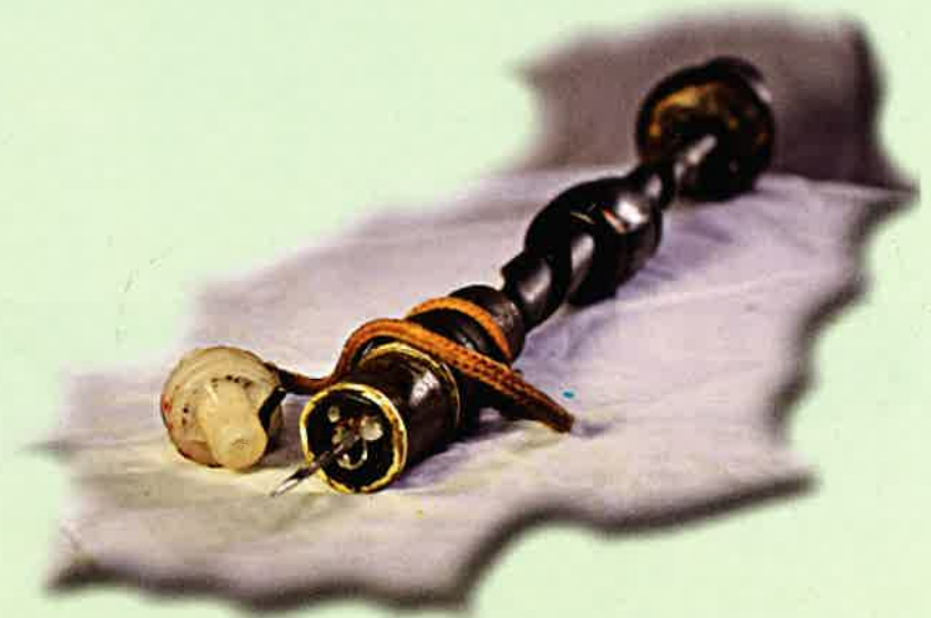
Foto 4.1 Mata bor diperbuat daripada besi yang ditajamkan.
